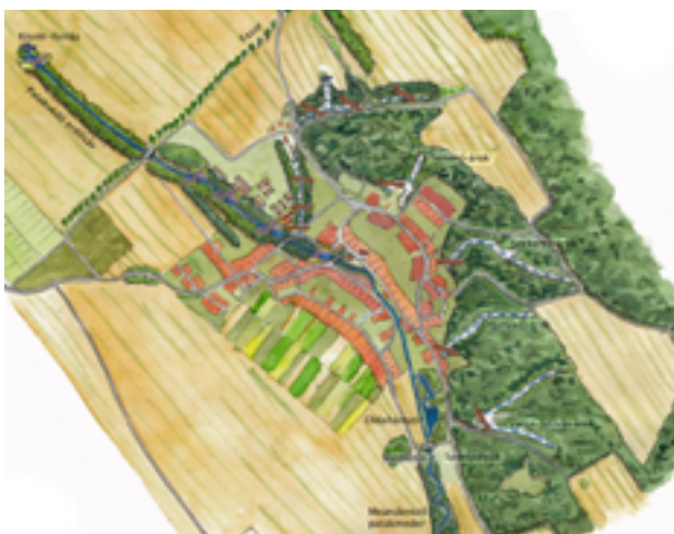
34. ábra: A tervezett lefolyáslassítási lehetőségek látványterve a Szilágyi-patak felső vízgyűjtőjén. (Készítette: Ruzics Csilla)
