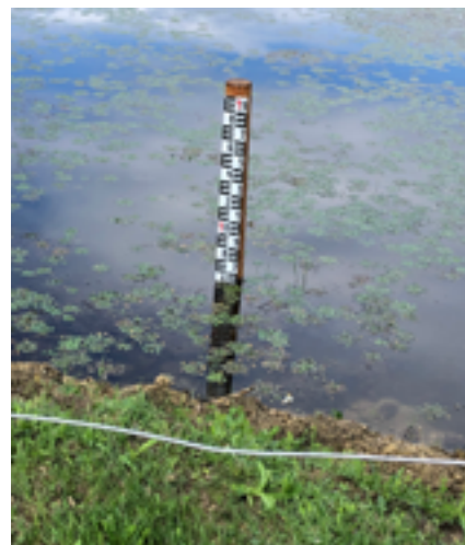
51. ábra: Telepített vízmérce Tiszatarjánban. (Fotó: Tiszatarján Község Önkormányzata)
