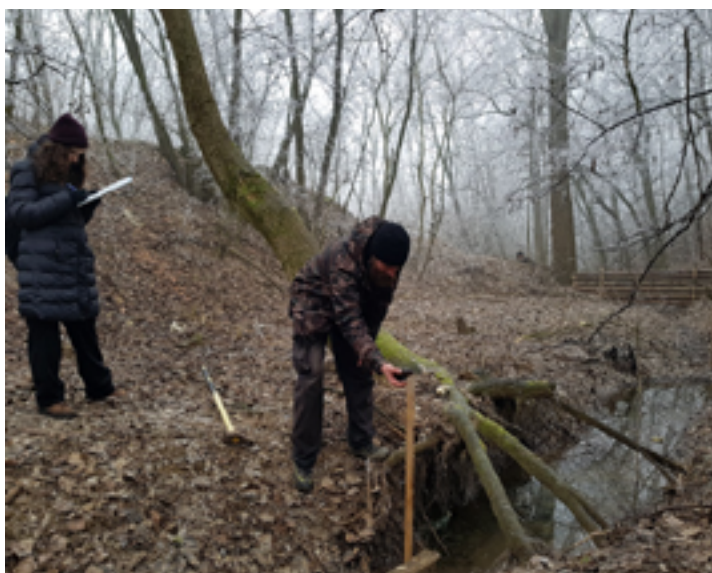
65. ábra: Egyszerű mérési rendszer kialakítása Püspökszilágyon, az eróziós árkokban elhelyezett hordalékfogó rönkgátak mögötti tározótér feliszapolódásának nyomon követésére. (Fotó: WWF Magyarország)
